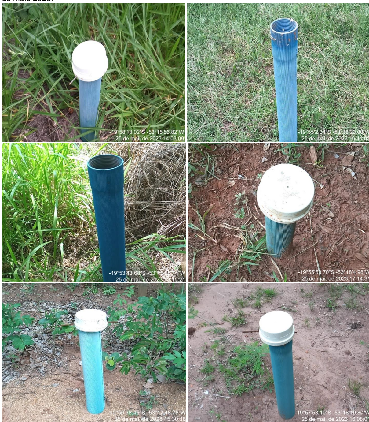
Figura 2 - Poços de monitoramento da PCH Verde 4. Pontos de cima para baixo: P1 a P6. Campanha de maio/2023.
