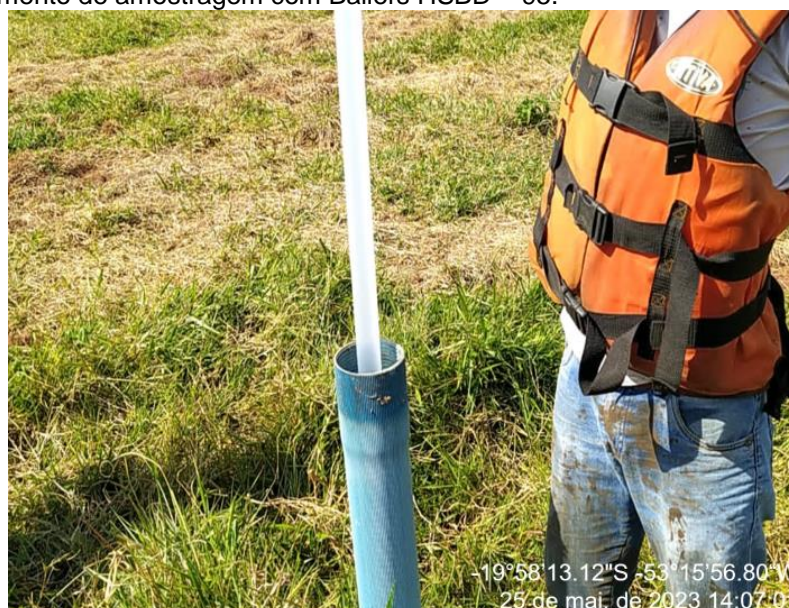
Figura 4 - Procedimento de amostragem com Bailers HSBD – 95.
