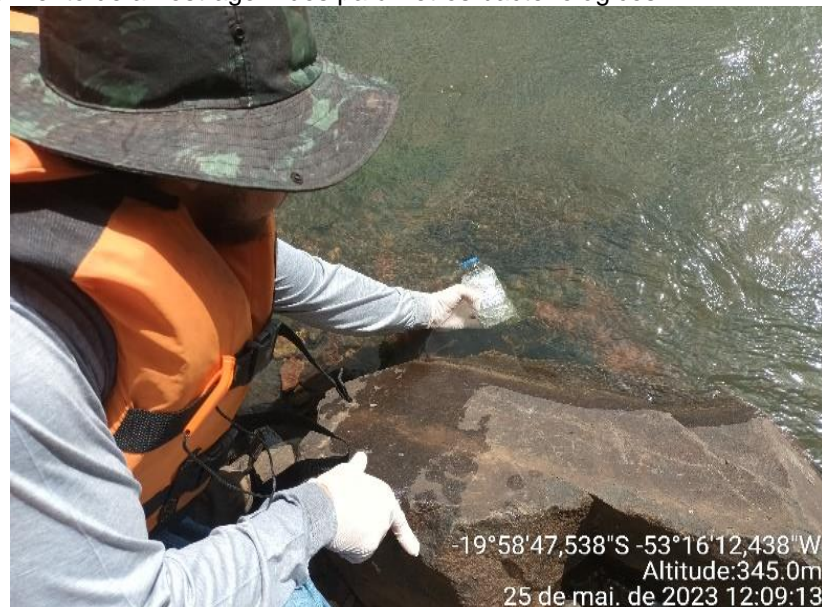
Figura 5 - Procedimento de amostragem dos parâmetros bacteriológicos.
